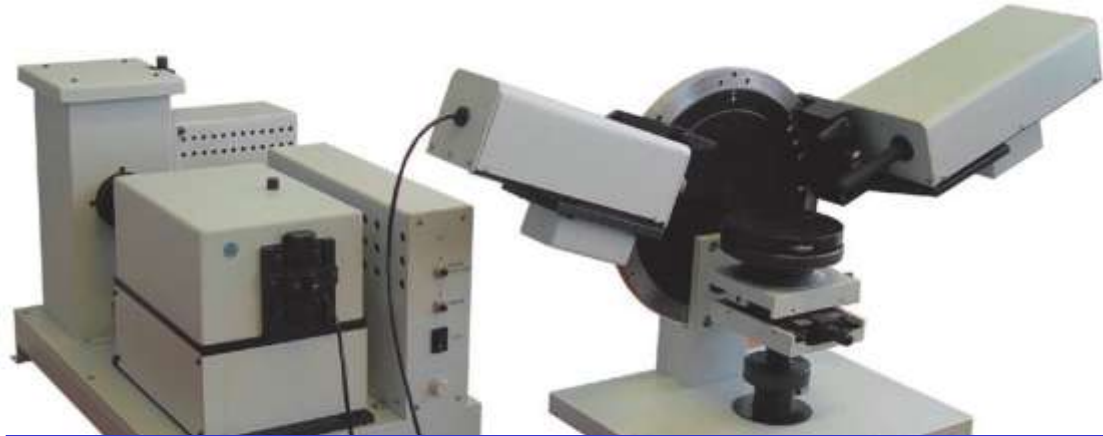
Спектроэллипсометр «Эллипс-1891» (ИФП СО РАН, г. Новосибирск)
