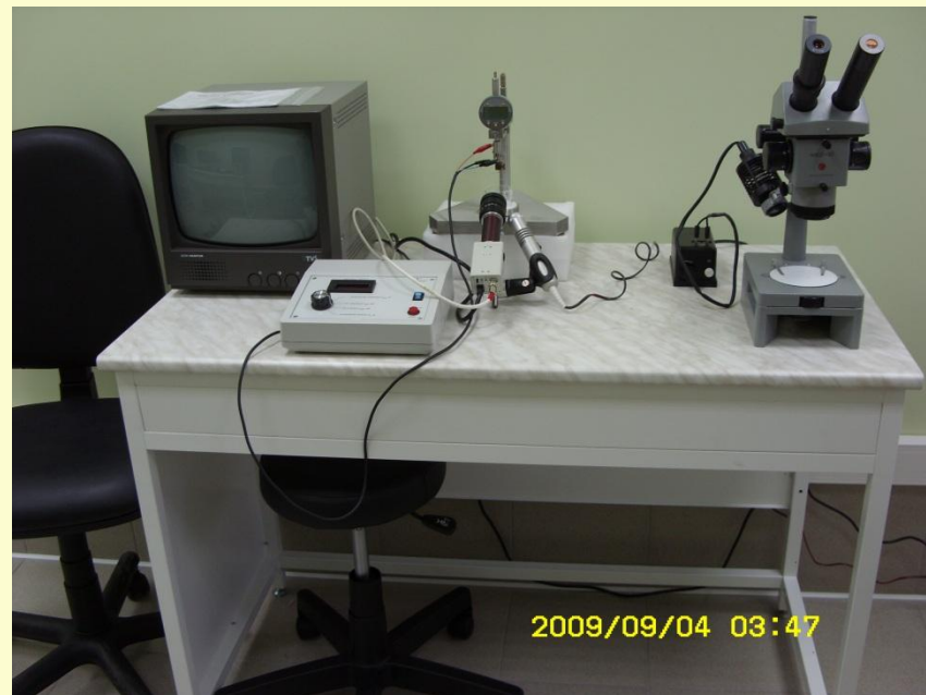
GPI-100A - установка формирования игл для зондовых микроскопов
