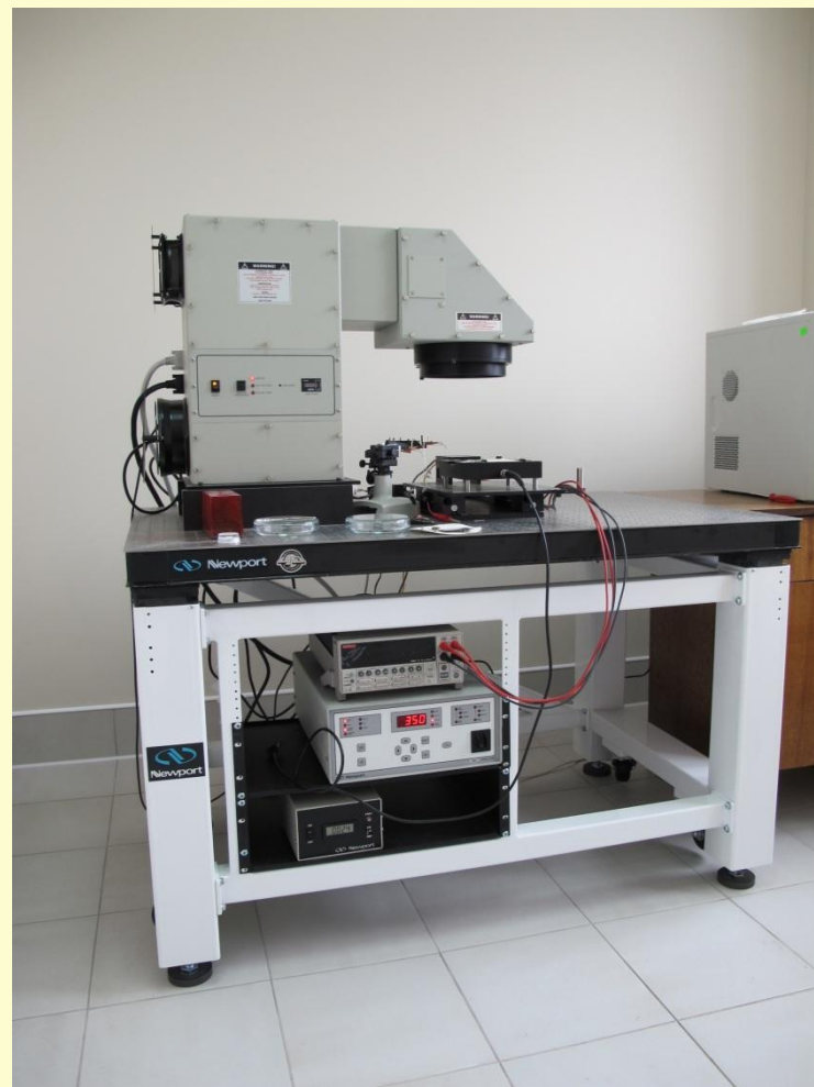
Установка для измерения характеристик солнечных элементов Oriel I-V
