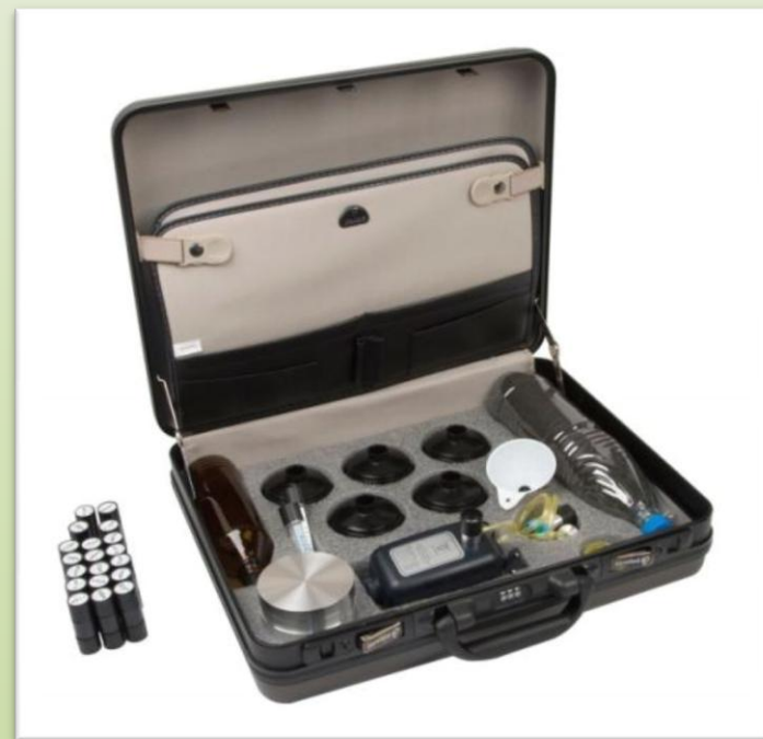
Комплект оборудования на основе активированного угля для комплексного мониторинга радона
