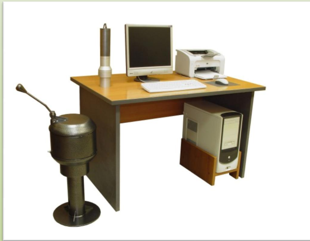
Общий вид установки на базе сцинтилляционного гамма-спектрометра «Прогресс-Гамма»
